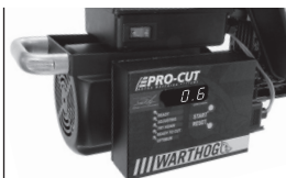
L'ordinateur a réglé le voile latéral à 0.0006 po et est prêt à réusinier.
