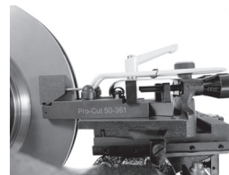
Le déflecteur de copeaux réduit la vibration et doit être utilisé à CHAQUE coupe.
